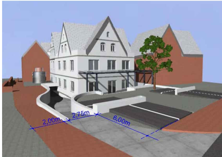
Umgestaltete TG-Zufahrt und Passagenverlängerung ( B=2,0 m) aus Richtung Neue Straße
