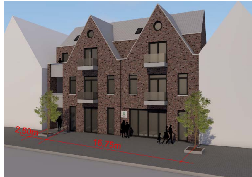
06 rotblauer Stein, versetzter, flächenbündiger Eingang Gewerbe (OLB), Balkone (entspricht nicht den Vorgaben OLB!)
