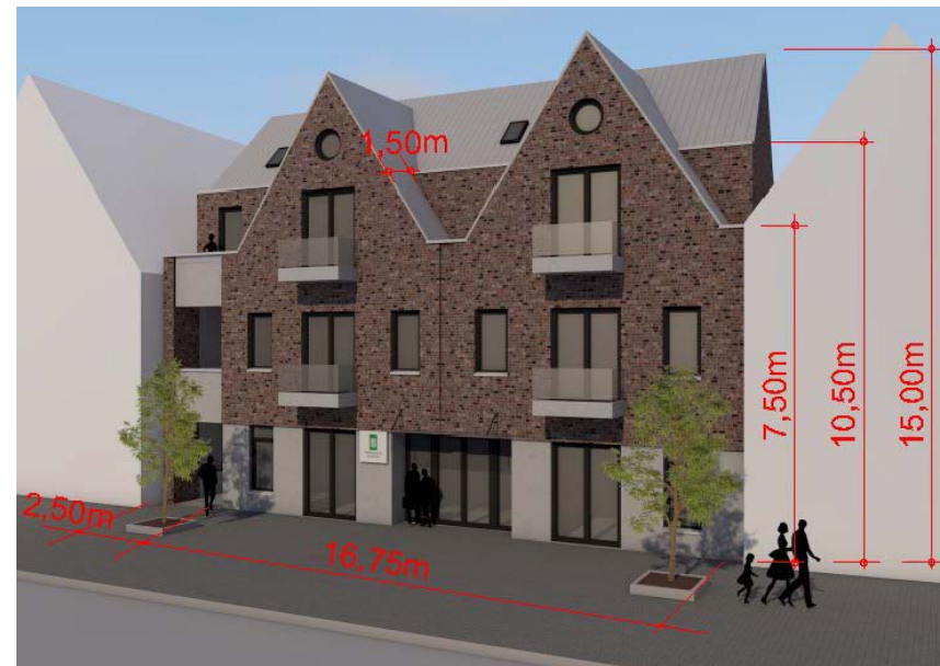
04 rotblauer Stein, mittiger Eingang Gewerbe (OLB), Sichtbeton im EG, Balkone
