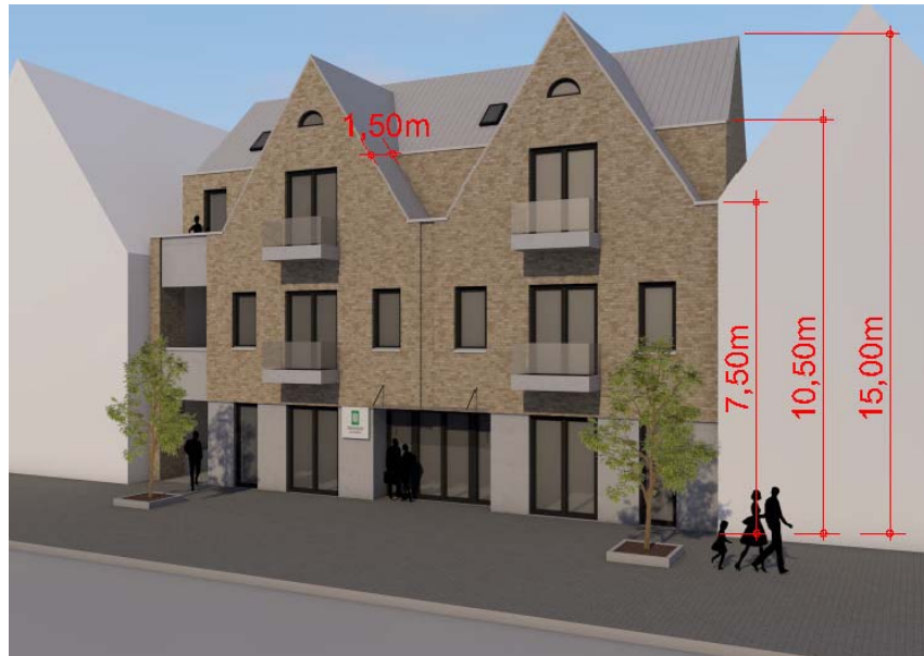
05 sandgelber Stein, Sichtbeton im EG, mittiger Eingang Gewerbe (OLB), Balkone
